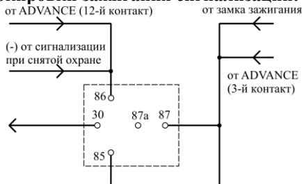
Рис. 4. – Нормально разомкнутое реле блокировки.
