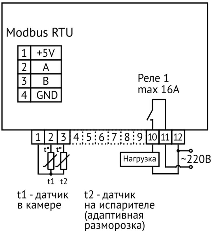
Рис. 1. Схема подключения блока
